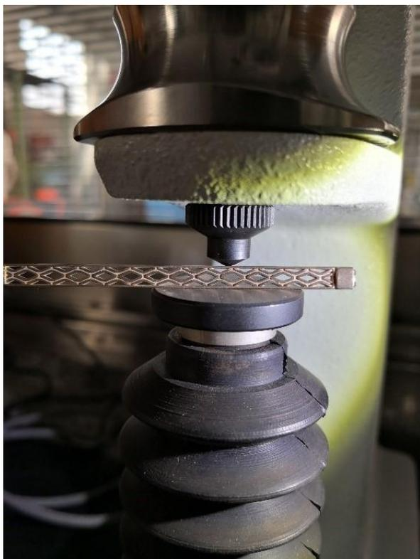
*Microdurometro Vickers HV5*
